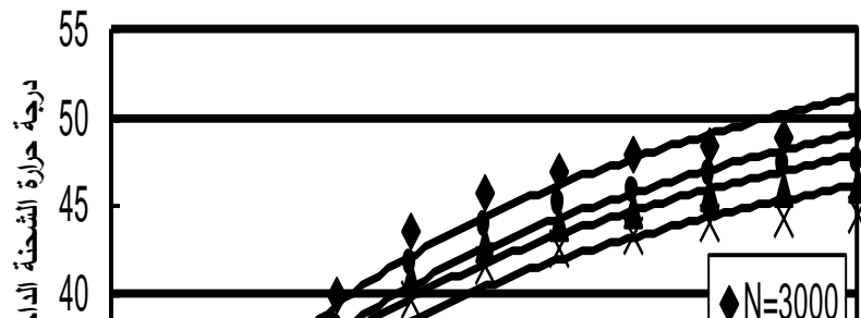
شكل (5) تغير درجة حرارة الشحنة مع السرعة الدورانية للمبادل ولعدة قيم من سرعة المحرك وعند درجة حرارة (10 °C) للمحيط.
